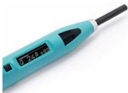
Obr. 3. Odrazový tvrdoměr Proceq SilverSchmidt Type L (stříbrný kroužek)
